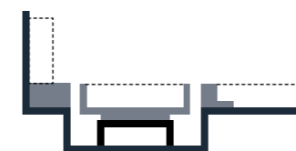
Řez odtokovým žlabem s rámečkem / řešením Cassette z kartáčované oceli.
