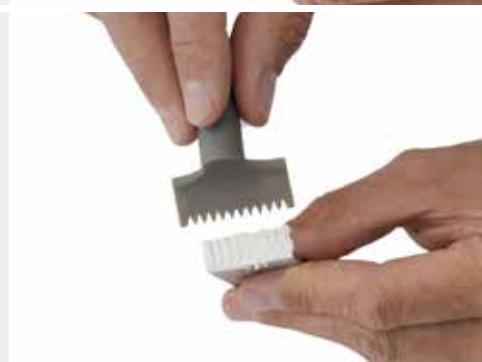
Træk "riven" gennem lim og væske på tværs et par gange for at sikre, at de to materialer bliver blandet.
