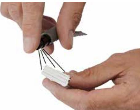
Aktywować klej poprzez bezpośrednie naniesienie płynu spryskiwaczem ręcznym.
